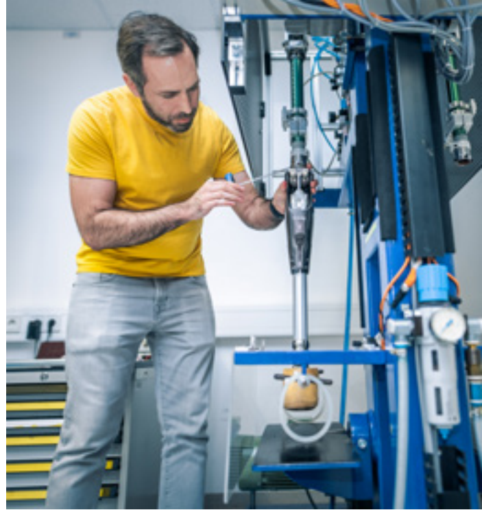
Facharbeiter Thomas Wassicek prüft ein C-Leg-Kniegelenk auf Belastbarkeit und stellt die Sensorik ein.
